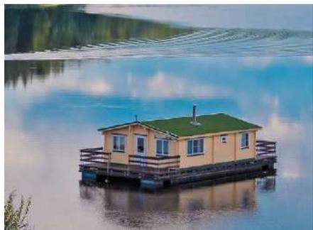
Понтонное основание (понтон) для плавучего дома имеет габаритные размеры 14,4 x 6,5 м. Его конструкция, на который установлена жилая надстройка, обладает повышенной устойчивостью и надежностью. Модули плавучести, поддерживающие понтон на воде, отличаются особой скругленной формой, благодаря которой при замерзании воды плавучий дом выталкивается на поверхность льда
