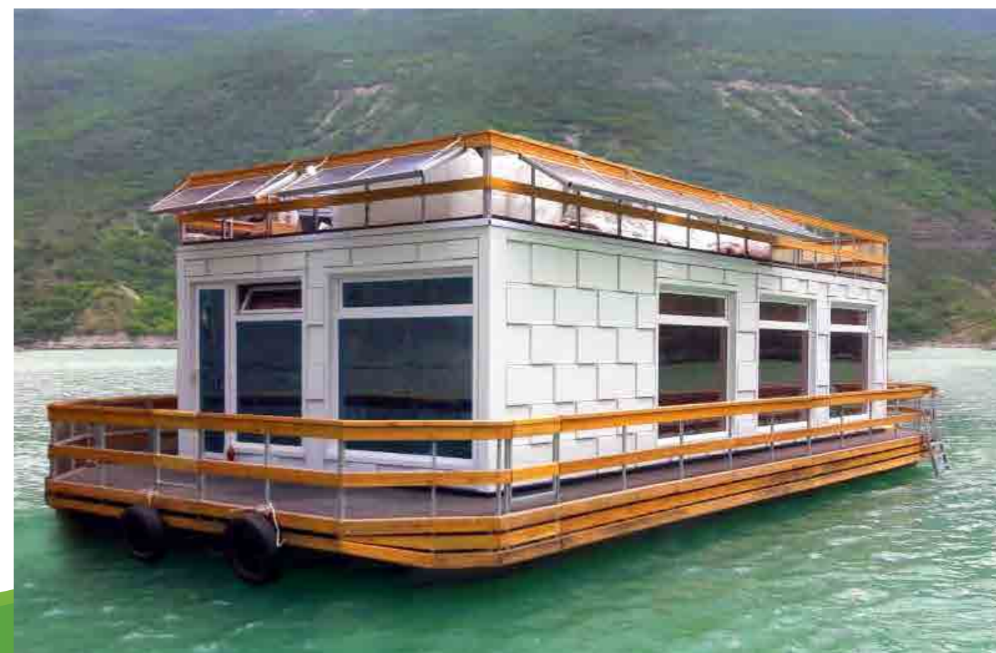
Понтон Остров-60 габариты: 9,7x6,2 м грузоподъемность: 3 т кол-во модулей: 62 шт.
